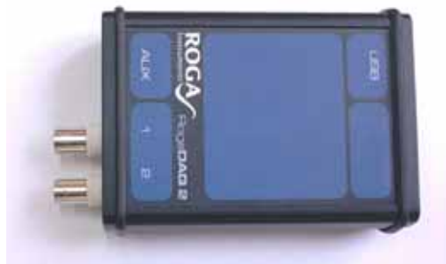
Fot. 5. Dwukanałowy rejestrator analogowo-cyfrowy RogaDAQ2
