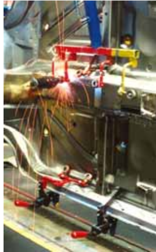
Fot. 1. Przykład punktowego źródła promieniowania optycznego na stanowisku pracy Phot. 1. Example of point source of optical radiation on a working place stand
