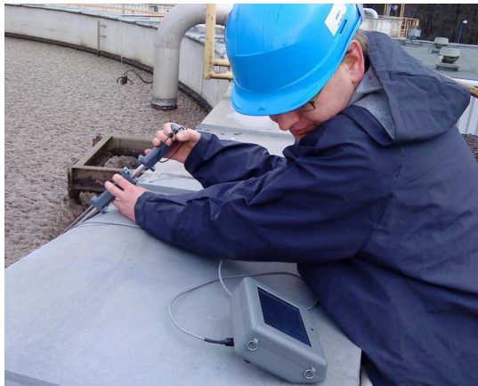
Fot. 2. Pomiar aktywności oddechowej osadu czynnego przy użyciu respirometru bezpośrednio w komorze osadu czynnego
