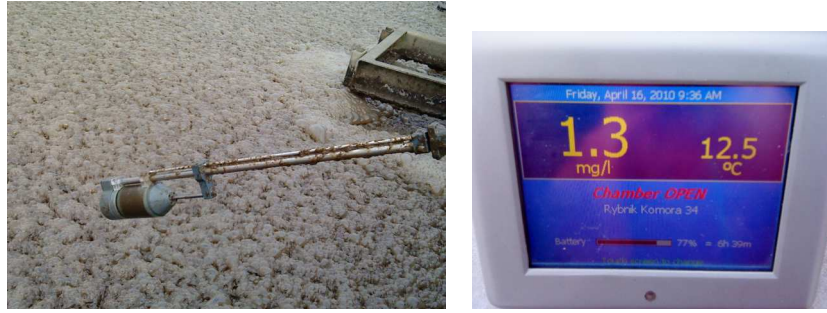
Fot. 1. Komora pomiarowa Bioscope oraz dotykowy ekran służący do sterowania urządzeniem, z możliwością natychmiastowego analizowania otrzymanych wyników
