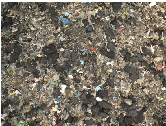
Fot. 2. Mieszanka węgla kamiennego z odpadem kod 19 12 10 odpady palne (paliwo alternatywne) użytym do badań w czasie spalania w kotle wodnym retortowym typu KMR 470N
