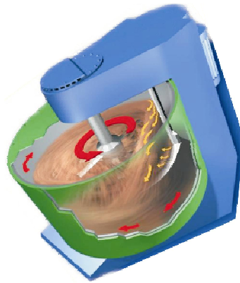
Rys. 2. Intensywny mieszalnik przeciwbieżny (Korol, Serkowski 2007)
