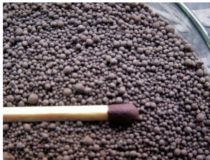
Fot. 4. Klinkier magnezjowy – surowiec do produkcji materiałów ogniotrwałych; uziarnienie 0,2–2 mm
