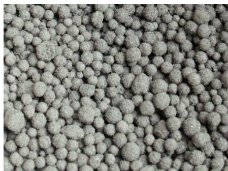
Fot. 8. Zасыпка металургична на базе odpadów z produkcji aluminium, tzw. zgarów; uziarnienie 4–6 mm
