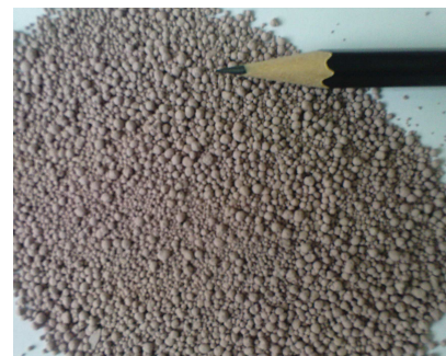
Fot. 5. Zgranulowany proszek ZrO_2 – surowiec do produkcji materiałów ogniotrwałych; uziarnienie 0,2–2 mm
