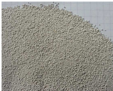
Fot. 6. Porcelana elektrotechniczna – granulát, uziarnienie 0,1–0,8 mm
