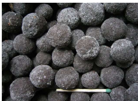
Fot. 9. Odpady z produkcji żelaza i stali, zawracane do procesu
