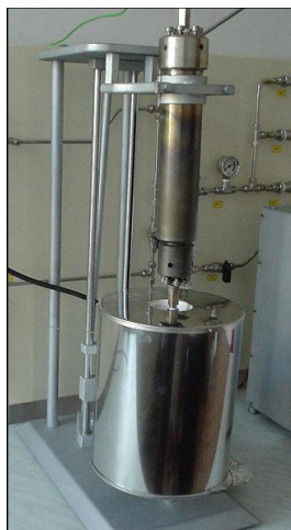
Fot. 4. Reaktor i piec oporowy zamontowany na statywie
