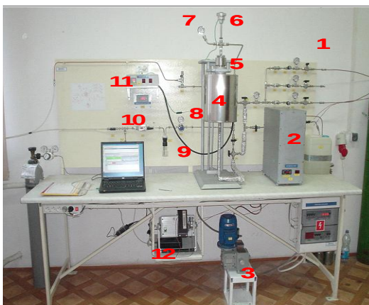
Fot. 1. Laboratoryjna instalacja do zgazowania węgla z reaktorem ze złożem stałym: 1 – wloty, zawory i regulatory przepływu gazu nośnego i /lub gazów reakcyjnych, 2 – wytwornica pary, 3 – pompa, 4 – piec oporowy, 5 – reaktor, 6 – termopara, 7 – ciśnieniomierz, 8 – regulator ciśnienia, 9 – tzw. pułapka wodna, 10 – przepływomierz, 11 – sterowanie komputerowe, 12 – przenośny mikrochromatograf gazowy
