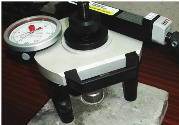
Fot. 5. Pomiar wytrzymałości próbki betonowej na rozciąganie przy pomocy urządzenia „dyna pull-off tester Z-25” firmy Proceq
