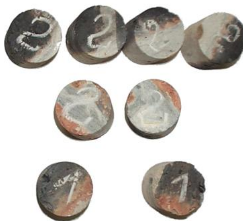
Fot. 7. Próbkę laboratoryjne wykonane z pobranych rdzeni Phot. 7. Laboratory samples made from extracted drill cores
