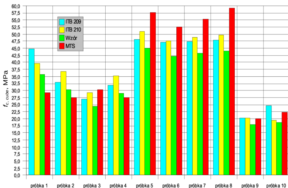
Rys. 7. Porównanie wartości uzyskanych wytrzymałości na ściskanie f_{c,cube} dla cegły: 1–10 numery próbek
