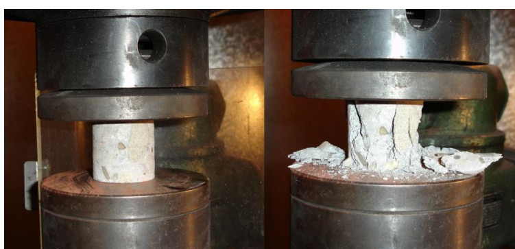
Fot. 8. Widok próbki przed i po badaniu w maszynie wytrzymałościowej ZD-30 Phot. 8. Appearance of a sample before and after test in ZD-30 testing machine
