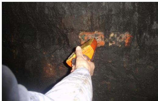
Fot. 2. Sposób pomiaru liczby odbicia w warunkach szybowych z użyciem mechanicznego młotka Schmidta
