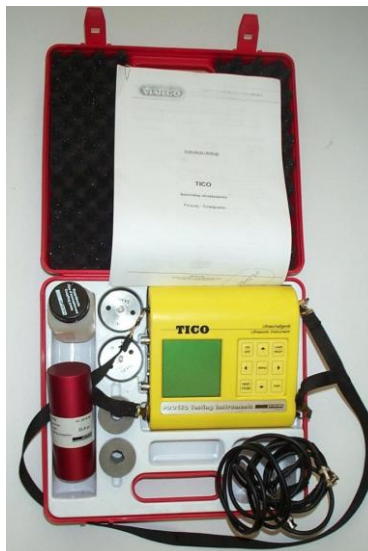
Fot. 3. Betonoskop ultradźwiękowy TICO firmy Proceq
