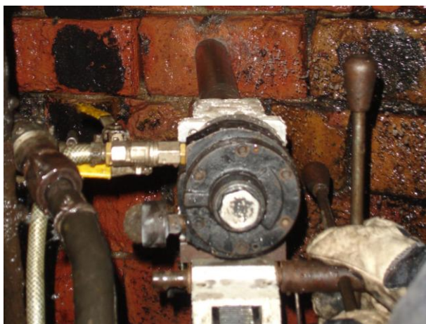
Fot. 6. Pobieranie prób z odwierćników rdzeniowych za pomocą wiertnicy pneumatycznej
