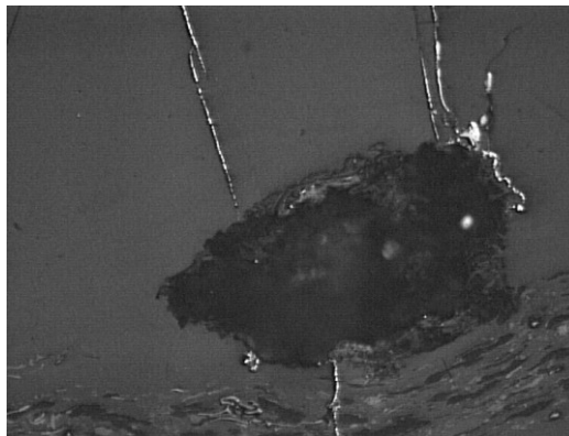
Fot. 12. Konkrecja ilasto-syderyticzna w otoczeniu żyłek pirytu w wityrycie Phot. 12. Concretion loamy – sideritic near pyrite streak in vitrite
