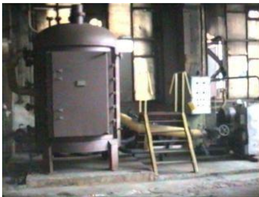
Fot. 1. Reaktor do zgazowania odpadów gumowych
