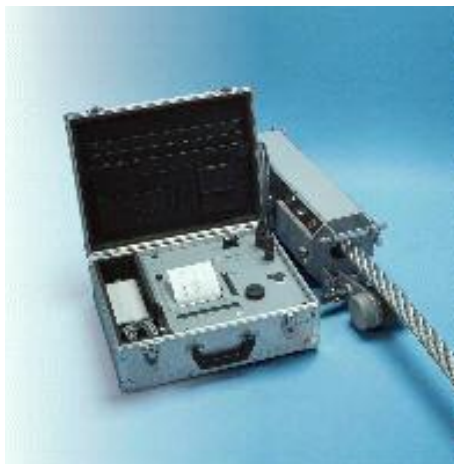
Fot. 1. Rejestrator i głowica magnetyczna do nieniszczących badań lin
