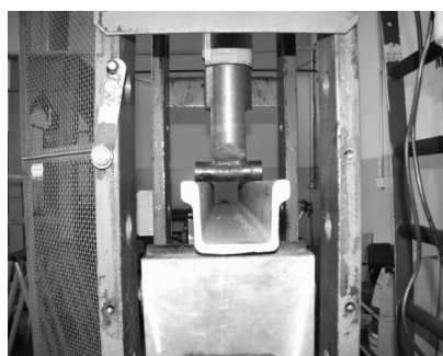
Fot. 3. Kształtownik KO21 na uniwersalne stropnice górnicze w czasie prób zginania
