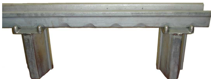
Fot. 1. Sposób posadowienia nowego kształtownika KO21 na stojakach z głowicą koronową Photo. 1. Way of placing of new KO21 section on props with a crown head
