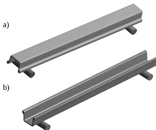
Rys. 7. Model kształtownika KO21 wraz z podporami usytuowany: a – „dnem w górę”, b – „dnem w dół”
