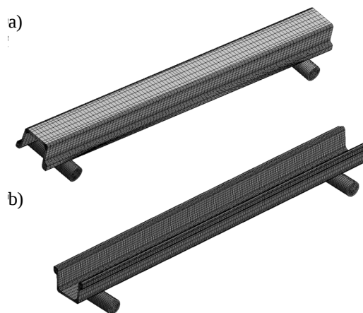
Rys. 8. Siatka elementów skończonych nałożona na modele kształtowników KO usytuowanych: a – „dnem w górę”, b – „dnem w dół”
