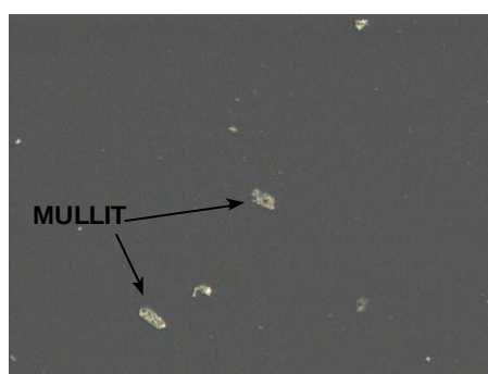
Rys. 14. Obraz mikroskopowy popiołu po syntezie z NaCl; światło przechodzące, skrzyżowane nikole, powiększenie 200×
