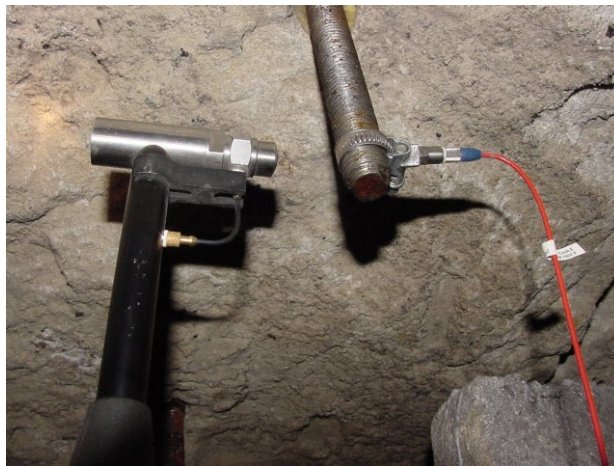
Fot. 2. Wymuszanie drgań młotkiem udarowym, sygnał odpowiedzi mierzony piezoelektrycznym przetwornikiem drgań
