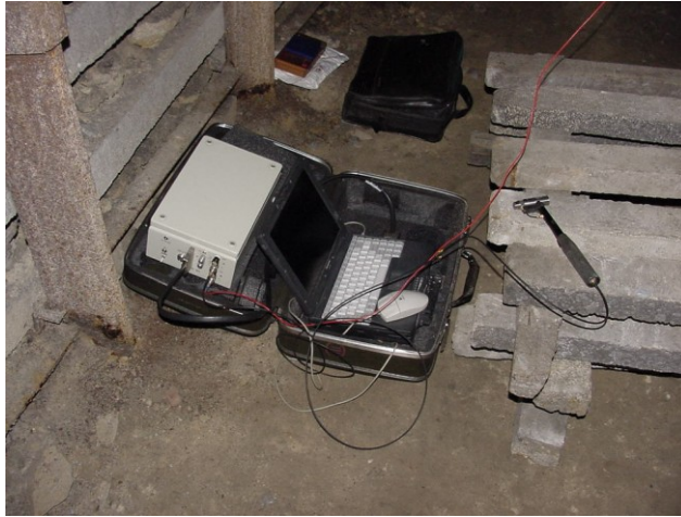
Fot. 1. Przenośny system akwizycji i rejestracji funkcji przejścia – PSAR-FRF; realizacja badań w warunkach rzeczywistych stosowania samodzielnej obudowy kotwiowej
