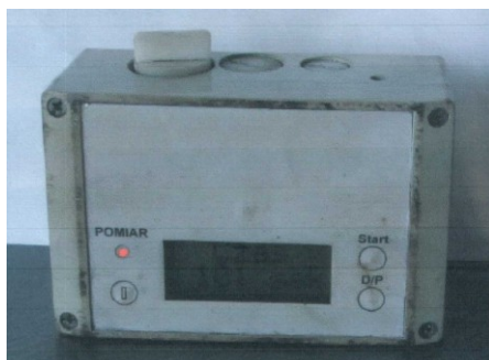
Fot. 1. Przyrząd do wyznaczania intensywności desorpcji gazu z węgla i szacunkowej zawartości metanu, pochodzenia naturalnego, w węglu (metanności) Phot. 1. Tool to show intensity of gas desorption from coal and empirical methane content, natural origin at coal (methanity)
