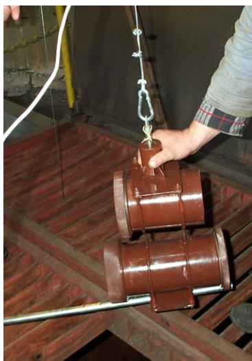
Fot. 1. Aparatura monitorująca przed opuszczeniem do badanego szybu (fot. M. Rotkegel)
