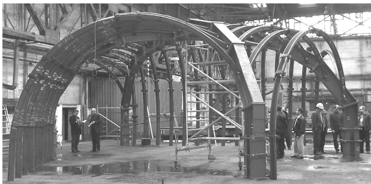
Fot. 6. Obudowa w czasie montażu próbnego (fot. M. Rotkegel)
