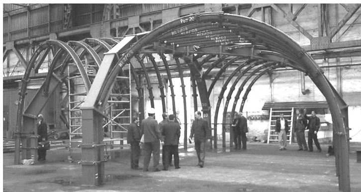
Fot. 5. Obudowa w czasie montażu próbnego (fot. M. Rotkegel)
