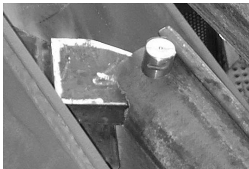
Fot. 2. Podcięcie w dnie kształtownika V (fot. M. Rotkegel)
