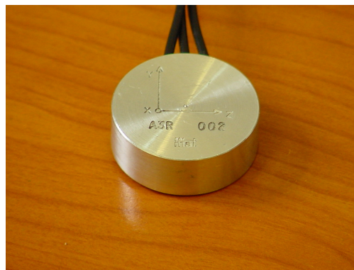
Fot. 1. Prototyp przetwornika drgań, typu A3R – widok ogólny
