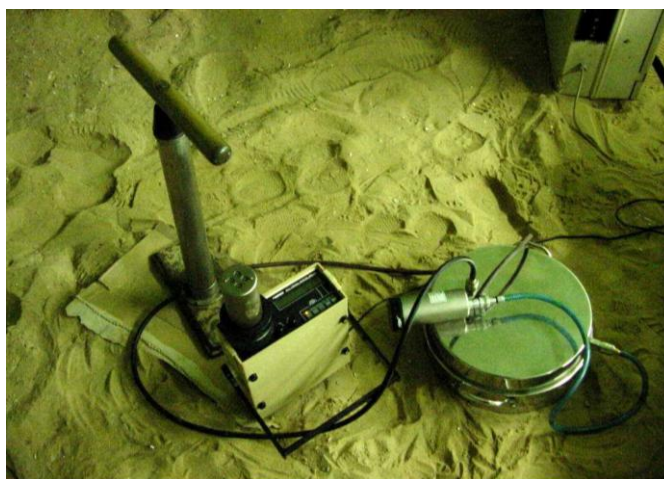
Fot. 1. Pomiar ekshalacji radonu z gleby wewnątrz komory radonowej z zastosowaniem przyrządu AB-5 firmy Pylon i komory Lucasa
