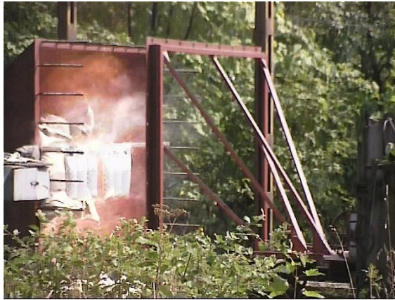
Fot. 2. Zapora pyłowa w momencie dojścia fali ciśnienia Phot. 2. Stone dust barrier reached by pressure wave
