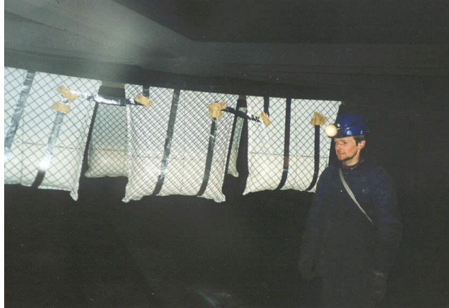
Fot. 1. Pojemniki typu zamkniętego zabudowane w zaporze przeciwybuchowej Phot. 1. Containers of closed type mounted in explosion suppression barrier
