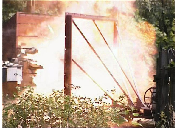
Fot. 3. Wynik działania fali ciśnienia na zapórę pyłową Phot. 3. Effect of pressure wave action on stone dust barrier
